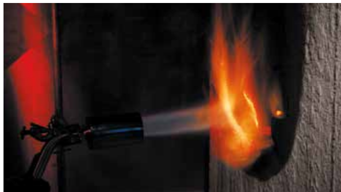
Вплив відкритого полум'я на утеплювач QuadCore (відсутність диму, не розповсюджує вогонь, не прогорає)
